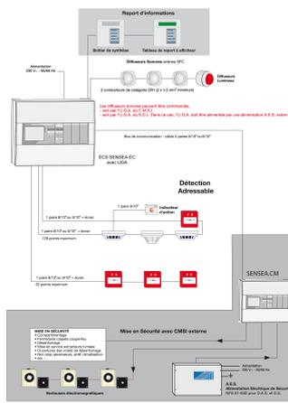
L'Équipement de Contrôle et de signalisation Sensea.EC a été conçu spécifiquement pour les bâtiment de taille moyenne à importante nécessitant un système de Détection Incendie Adressable.
