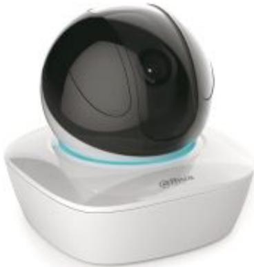
Dahua IPC-A26. Caméra compacte WiFi IP Dahua Consumer de 2MP avec positionneur PAN/TILT et éclairage infrarouge de 10 m d'intérieur. Format H.265/H.264. CMOS 1/2,9" de 2MP. Résolution digital de 2MP@25IPS. Optique fixe de 3,6 mm (84°). Zoom digital 16X. Capteur vidéo, région et temps configurable, suivi intelligent. Audio bidirectionnel. Fente MicroSD. Port Fast Ethernet. Compatible EvoCloudIp. Onvif, CGI. 5V CC. Bouton de réinitialisation/WPS. Ipc-a26.
